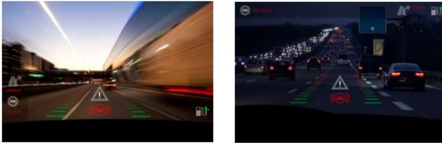
图 6 - 跟 AR 一样，HUD 也会将数字图像叠加到现实环境中。因此，所投射的图像在各种背景下的清晰度将会涉及重要的安全问题。图像必须足够清晰，确保在白天、夜晚以及各种天气条件下都清晰可辨。
