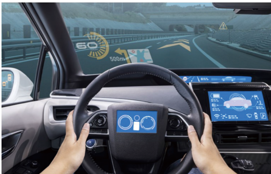
图 1 - 跟 AR 显示器一样，HUD 投影必须在精确位置上清晰可见，确保能够投射到远景上。通过确保 HUD 图像位置、色彩、亮度和清晰度的正确性，可以强化驾驶者对周围环境的感知，尽可能减少可能引起驾驶者分心失误。
