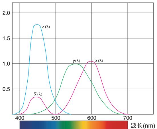
如在图19 b 中所示，三刺激法利用三个经过过滤的传感器使具有与人眼相同的 $\bar{x}(\lambda)$ ， $\bar{y}(\lambda)$ ， $\bar{z}(\lambda)$ 灵敏度来测量物体的反射光，从而直接测量三刺激值X,Y和Z。另外图中，分光光谱分析法利用复合传感器(在CM-2600d中有40个)来测量物体在每一个波长或每一个窄波长范围内的光谱反射比。于是该仪器的微计算机根据光谱反射比数据通过积分来计算三刺激值。对例中所用的苹果，三刺激值为X=21.21，Y=13.37,Z=9.32；这些三刺激值于是可用来计算其他色空间如Yxy或L\*a\*b\*中的值。
