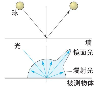
在光滑度高的物体表面上，镜面反射光相对就更强一些而漫射光弱一些。在那些低光泽度的粗糙表面上，情况则相反。当我们在镜面反射角位置观察表面光滑的蓝色塑料物体时，物体就显得不那么像蓝色，这是因为光源产生的镜面反射光被添加到了物体颜色里。通常来说人们在观察物体颜色时都忽略镜面反射光的。因此，在测量这类样品时，为了能使数据和物体看上去的一样，必须排除镜面反射光而只测漫射光。一个物体的颜色呈现出不同，就是因为我们在观察到的镜面反射光含量不同。
