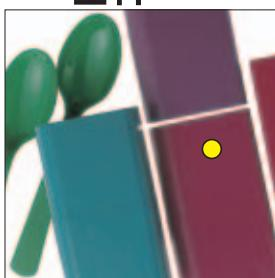
我们测量一块紫红色的塑料部件，在400nm和700nm左右波长区内光谱反射率高，而从500到600nm波长区内光谱反射率低，而且我们可以看到这一波长区的光已被吸收。
