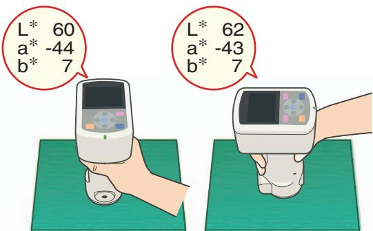
因此，在比较两个或多个型号的重复性时，不能只比较产品目录中的“规格值”。不同测色仪制造商对“规格值”的定义各不相同。尽管在某些情况下规格值与测色仪的实际测量能力大致相同，但在有些情况下，“规格值”比实际测量能力大得多。因此，建议借一台演示装置，亲手测试每个型号的能力。
