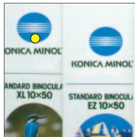
我们测量了蓝色的商标。它的光谱反射比几乎与B的光谱反射比相同。但如果我们仔细查看，我们可以注意到在波长长于600nm时光谱反射比更低。所以这是稍暗一点的蓝色。
