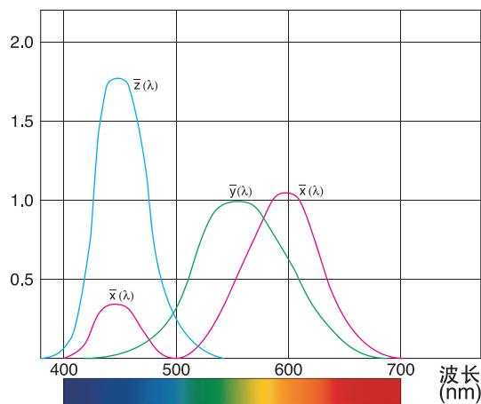
XYZ三刺激值和相关联的Yxy色空间构成了当前的CIE色空间的基础。XYZ三刺激值的概念是以色视觉的三元理论为根据的，它说明人眼具有接收三原色（红、绿、蓝）的接受器，而所有的颜色均被视作该三原色的混合色。1931年CIE制定一种假想的标准观察者，它具有如下列图6所示的配色函数和 $\bar{x}(\lambda)$ 、 $\bar{y}(\lambda)$ 和 $\bar{z}(\lambda)$ 。XYZ三刺激值是利用这些标准观察者配色函数计算得来的。
