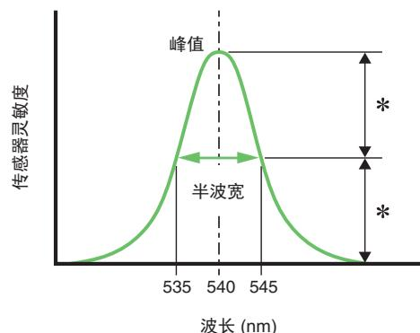
如果传感器半带宽较大，则会观察到较宽的波长范围，因此测得的结果将呈钝波形。为精确测量原始光谱特征，应减小半带宽。换句话说，测色仪的半波宽是“测量单色光的能力”。
