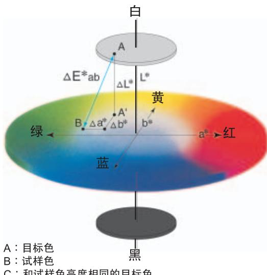
不论在何处只要用到颜色，最头痛的问题就是细微的色差。但是用了色彩色差计，即使细微的色差也可以用数字表达出来而且容易被人所理解。让我们用L\*a\*b\*和L\*C\*h色空间来看一下两个苹果之间的色差。用苹果①的颜色(L\*=43.31,a\*=+47.63,b\*=+14.12)作为标准，如果我们测量苹果②的颜色(L\*=47.34, a\*=+44.58, b\*=+15.16)与苹果①的颜色之差，我们得到下面显示器A所表示的结果。色差则在图14上的图形上表示出来。
