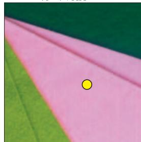
我们测量了布匹的粉红色区域。整个波长范围的光谱反射比是高的，特别是在600nm左右。另外，在500nm左右的光谱反射比较低，说明绿光和黄光被吸收。
