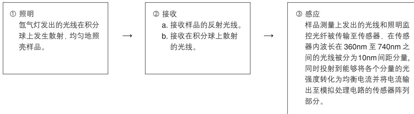
本仪器使用符合CIE的No. 15, ISO 7724/1, ASTM E1164, DIN 5033 Teil 7, 和JIS Z8722-1982(漫射照明系统/垂直观测系统)标准的d/8光学系统，并且可以同时进行SCI(含镜面反射光)和SCE(不含镜面反射光)的测量。
