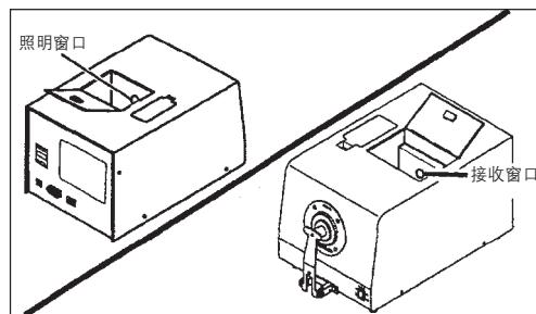
3. 打开样品固定器并用吹气球去除灰尘和污垢。
