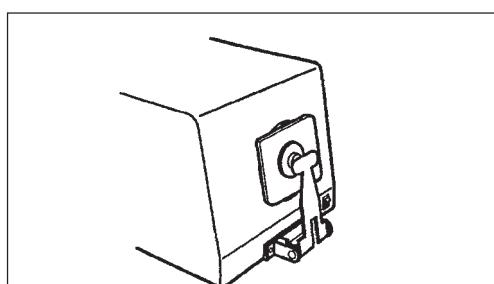
3. 打开取景器盖并检查测量点。
