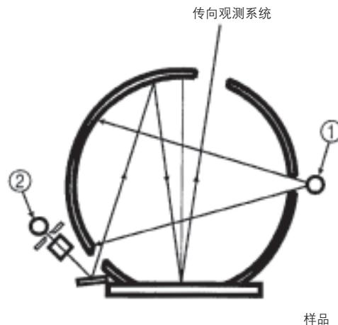
在进行每个测量时通过执行上述测量和计算，无需进行机械切换即可以同时获取 SCI 和 SCE 测量数据。
