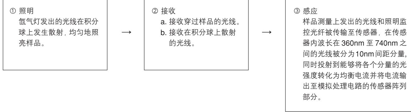
本仪器使用符合CIE No. 15, ASTM E1164, 和DIN 5033 Teil 7标准的d/0光学系统。
