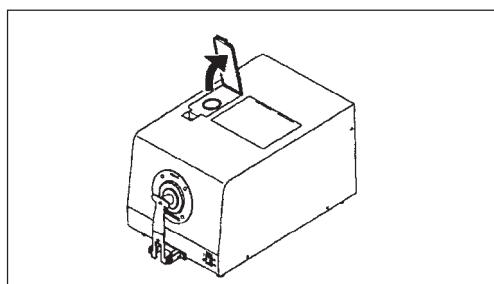
4. 调整样品以使测量口径处于测量孔径正中，然后关闭取景器盖。
