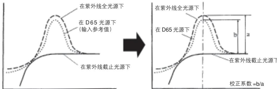
这些校正系数用于获取在紫外线全光源和紫外线截止光源下使用测量反射色进行数值计算得出的荧光反射色。
