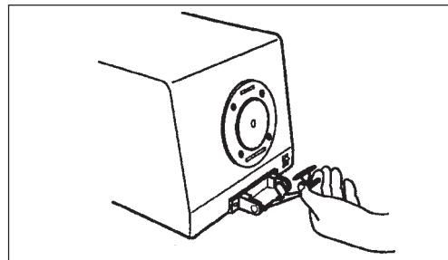
2. 将样品支架插入右图所示的白色校正板后侧的凹槽中固定白色校正板。
