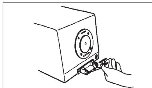
2. 将校零盒插入 CM-3600d 上的凹槽，然后关闭样品固定器以固定校零盒。
