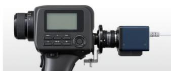
可通过在目镜处安装适用于 C 卡口镜头 CCD 的适配器来取景
