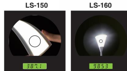
自动模式可根据被测物体亮度自动选择最合适的测量时间。
