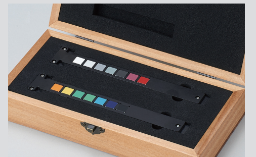
色板让用户能够轻松检查 FD-9 的测量值是否正确。
