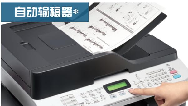
有了自动输稿器，您再也不用担心文件的连续复印。bizhub 3080MF 系列产品标配容量为 35 页 / 分钟的自动输稿器，让您在使用盖板复印厚重书本时多一种选择。
