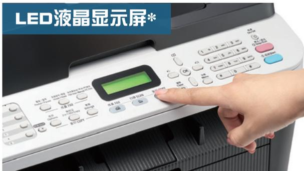
专为中国用户设计的 LED 显示屏，可以显示 2 行 10 个简体中文字或 20 个英文字符。为您提示多种操作步骤，轻松完成文印输出。
